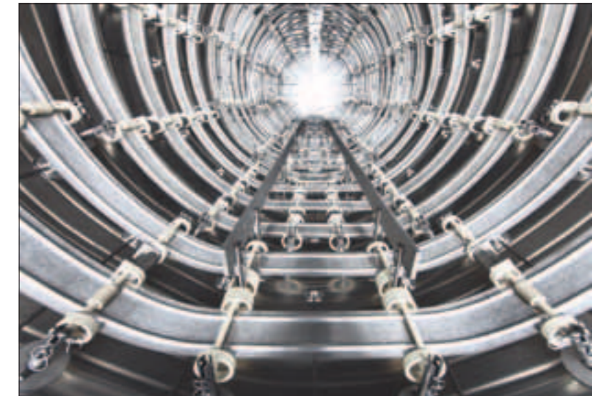
Die neue Ipsen Blechstrahl-Heizkammer für das Hartlöten und das Hochtemperaturlöten
