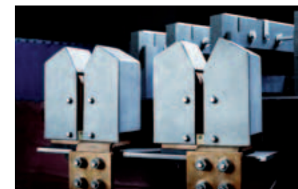
Stromkupplung eines vertikalen Vakuumofens
